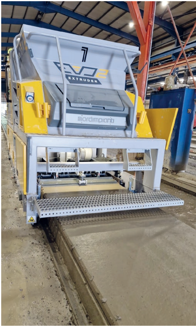
Les deux machines d'extrusion EVO2 installées à l'usine de Creagh Concrete
